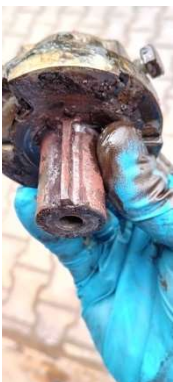
Komorska 11/15 – uszkodzone elementy bramy garażowej na poziomie 0
